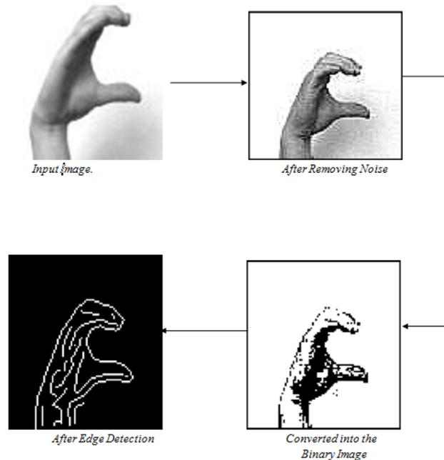
**Fig. 4.** Edge detection by Canny Edge Detection Algorithm
